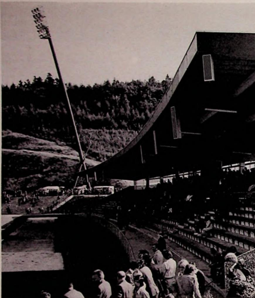
Bild 4. Beschallung eines Stadions von der Tribünenseite aus
